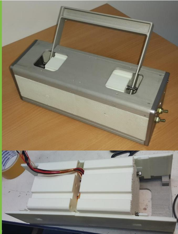
Спутник «Томск-ТПУ 120» - первый космический аппарат, **корпус** которого **изготовлен на 3D-принтере**.
