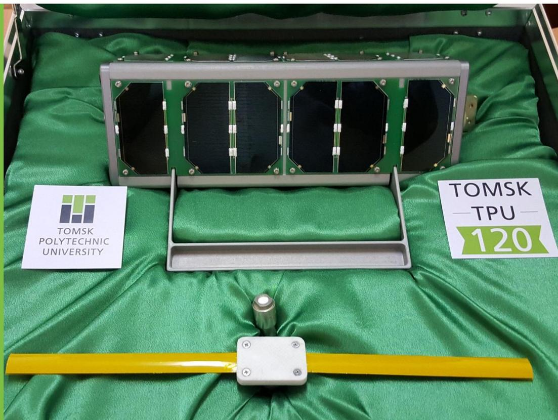
Первый спутник, созданный с использованием 3D-технологий.
