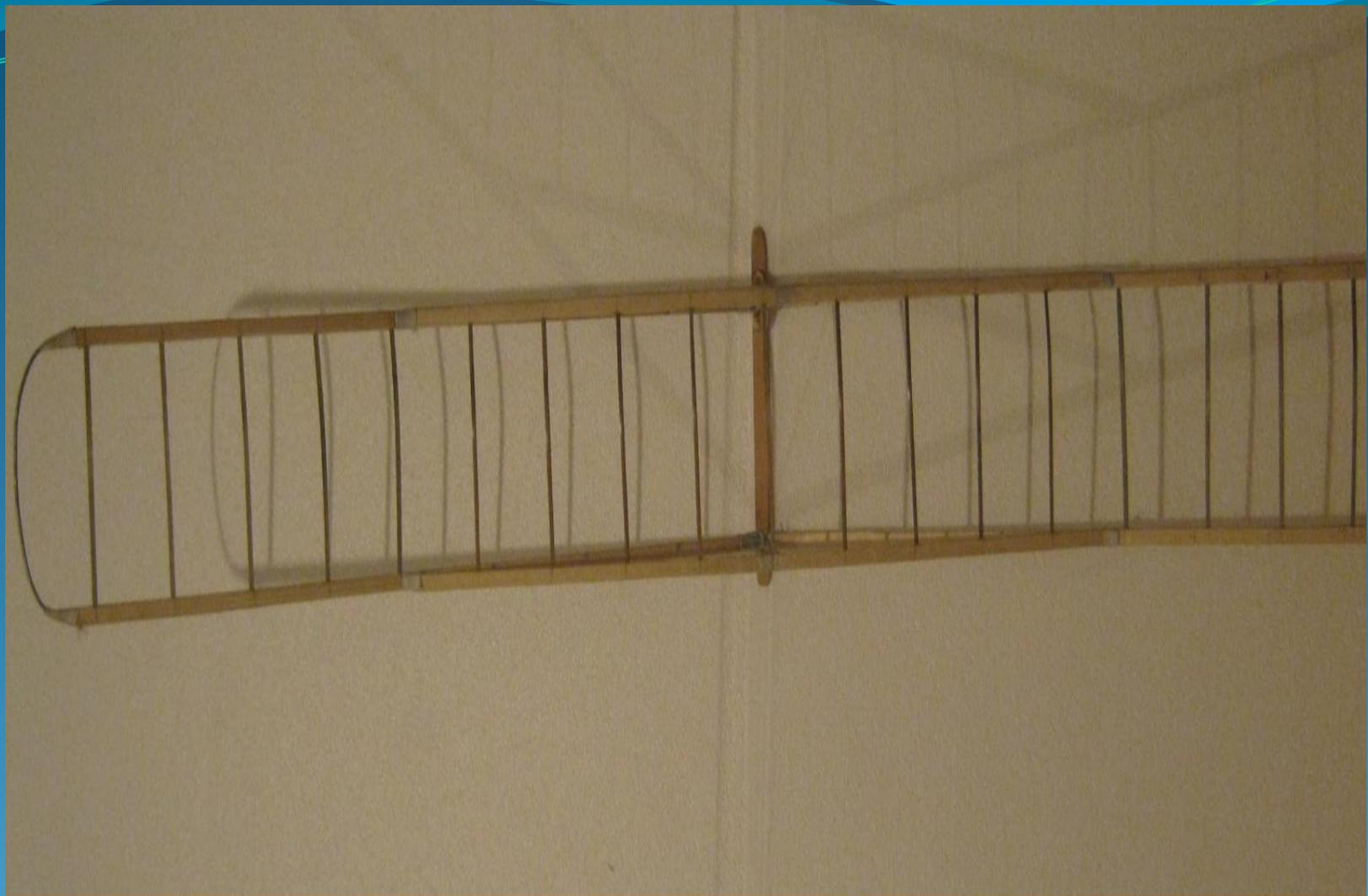
Нервюры крыла этого схематического планера изготовлены из бамбука
