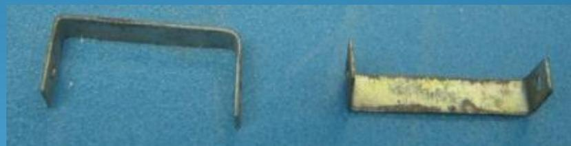
Саморезами длиной 1 см закрепляем эти скобы на профилированном бруске
