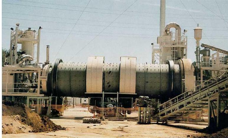
Особенностью технологии ATP является то, что термическое разложение и «осушка» нефтяного сланца, равно как горение, переработка и охлаждение осуществляются в одной вращающейся многокамерной горизонтальной реторте.
