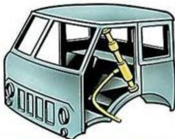
Надежно устанавливайте растяжки при правке перекосов кузова
