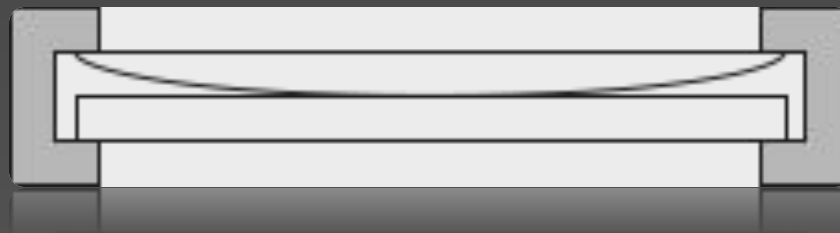
Схема оптичної системи для спостереження кілець Ньютона
