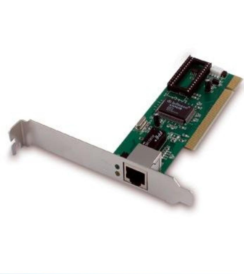
**Сетевая карта** – плата, устройство, устанавливается в материнскую плату или встроено в нее. Сетевая карта служит для соединения компьютера с другими компьютерами по локальной сети или для подключения к сети Интернет.
