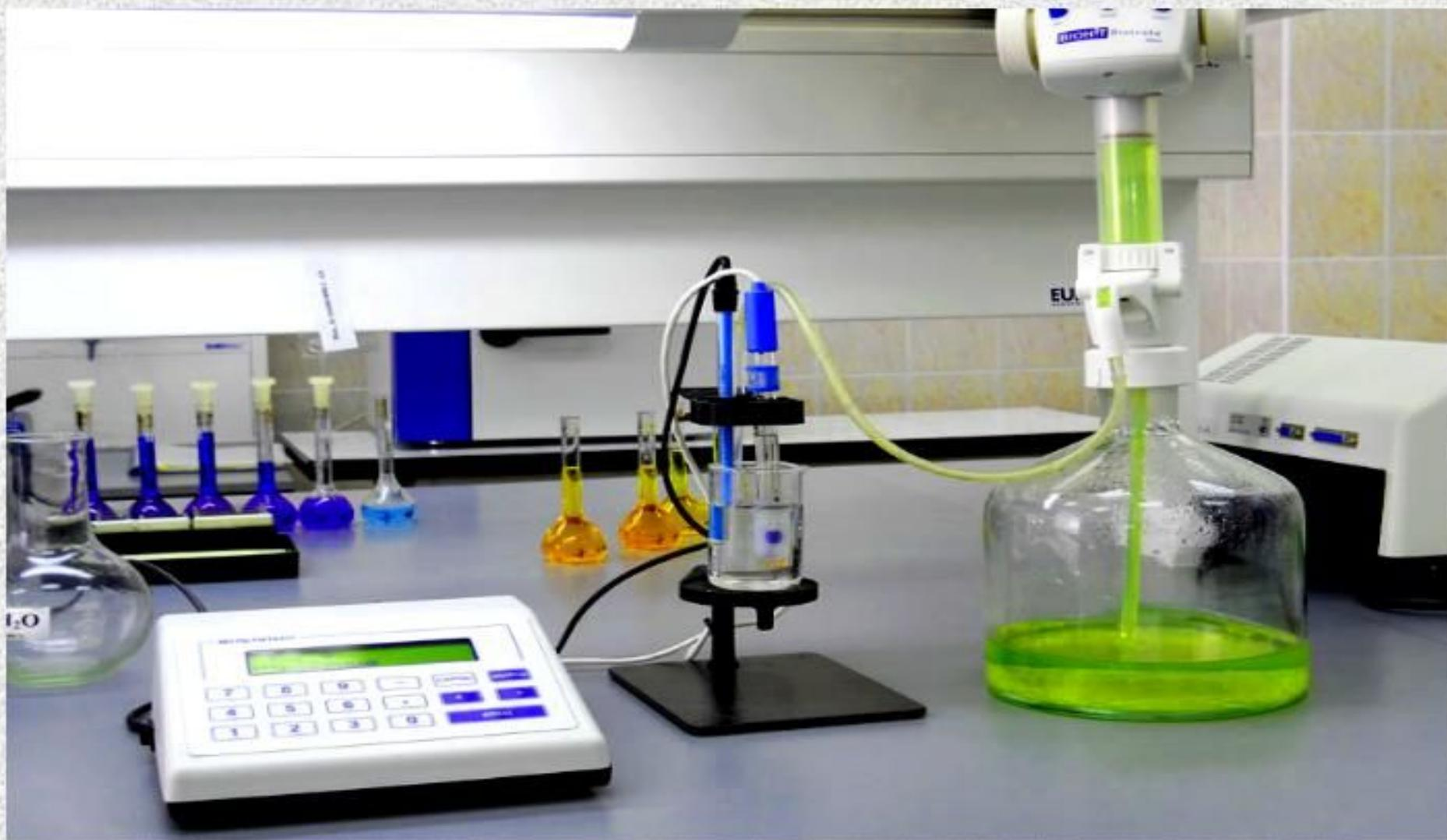
**Типичная установка амперометрического титрования**
