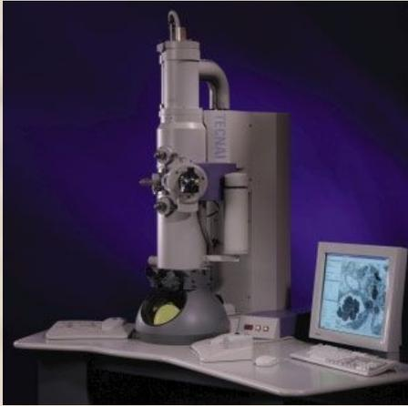
Изображение ЭМ формируется магнитными полями так же, как световое – оптическими линзами.
