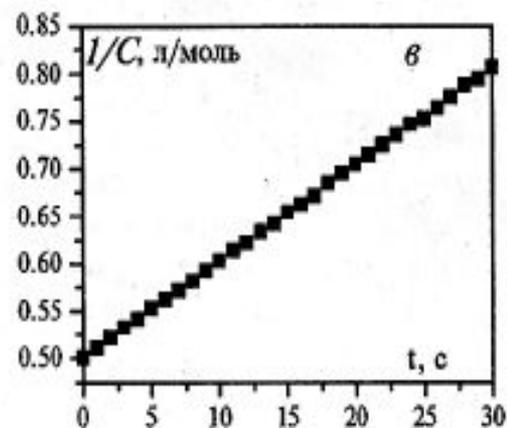
Кинетические кривые для реакции второго порядка в координатах спрямления для реакции нулевого (а), первого (б) и второго (в) порядка
