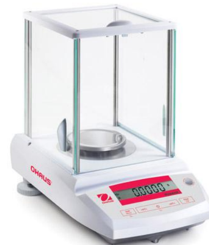
Весы лабораторные с допустимой погрешностью взвешивания \pm 1,0 г по ГОСТ 24104 .
