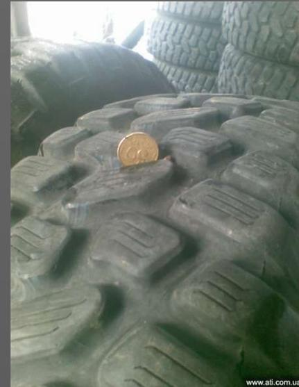
2. Шины имеют местные повреждения (пробои, порезы, разрывы) обнажающие корд. А также расслоение каркаса отслоение протектора и боковины.
