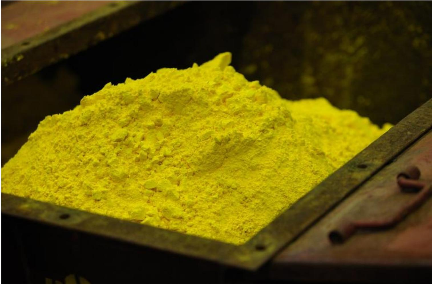
Обогащенный урановый газ переводят в твердое состояние – диоксид урана. Чистый твердый  $^{235}\text{U}$  уран позже дробят в урановый порошок.
