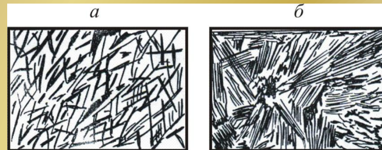
Рисунок 7 - Микроструктура мартенсита: а – игольчатого, б – речного
