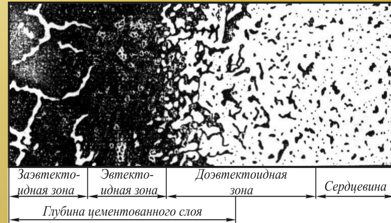
Рисунок 11- Схема структуры цементированного слоя в стальном изделии
