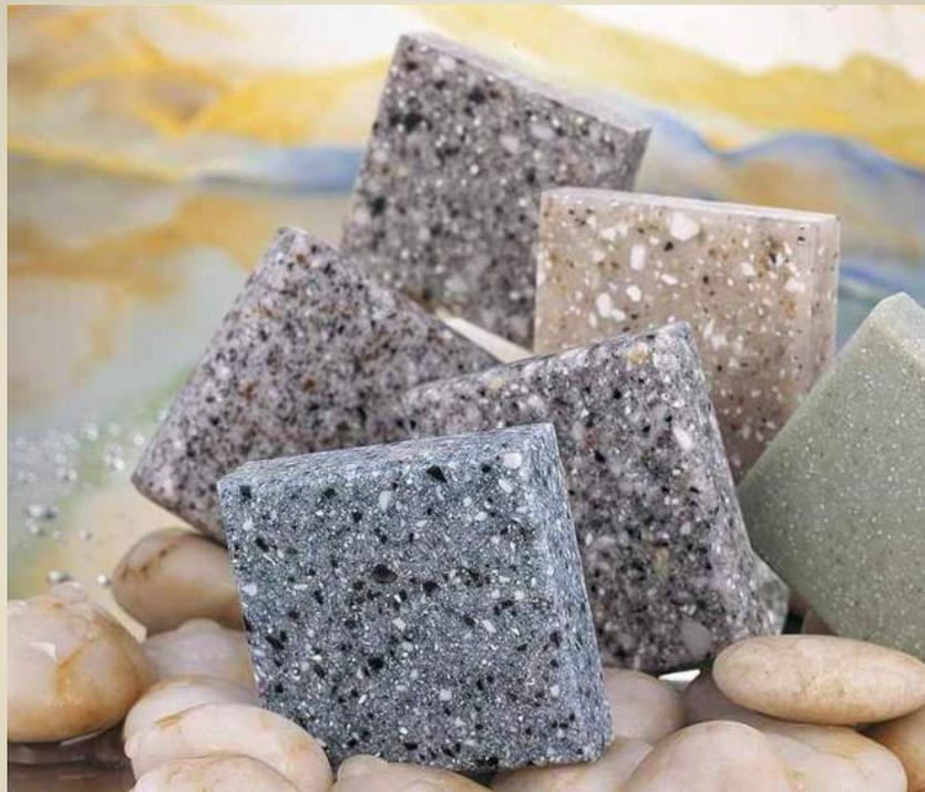
Рисунок 1-Образцы полимербетона.
