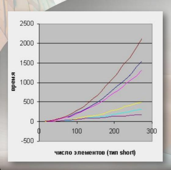
сортировка пузырьком шейкер-сортировка сортировка выбором
