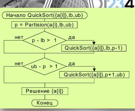
Блок-схема алгоритма быстрой сортировки
