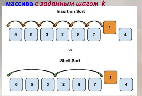
Такая модификация метода сортировки позволяет быстро переставлять далекие неупорядоченные пары значений (сортировка таких пар обычно требует большого количества перестановок, если используется сравнение только соседних элементов)
