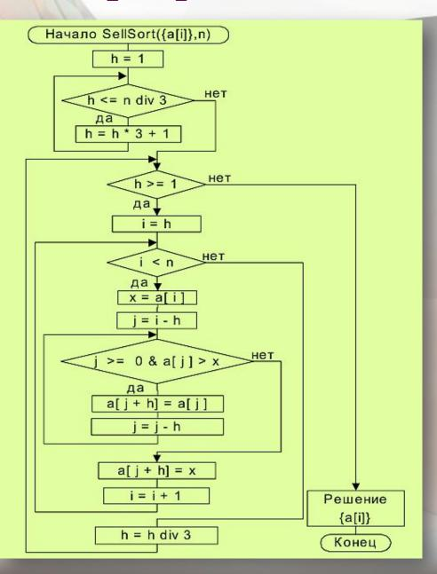
Блок-схема алгоритма сортировки Шелла с выбором шагов, предложенных Кнутом:
