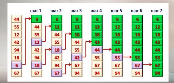
Запомнить, производился ли на данном проходе какой-либо обмен! Если нет – алгоритм заканчивает работу
