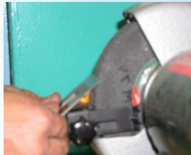
Затачивают (стачивают) на режущих инструментах обычно меньшую из поверхностей лезвий, например на ножах рубанков и стамесок — заднюю поверхность (смотри рис.). При этом снимается меньший объем металла лезвия, экономятся инструменты, трудозатраты и время.
