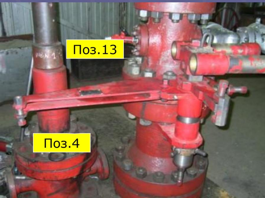
Установить на кронштейн 4 цилиндр поворота 19 и закрепить его пальцем 14 с гайкой.
