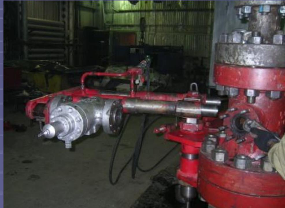
Зафиксировать положения подъемного и упорного винтов при помощи контргаек.
