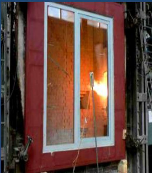
**Противопожарное окно** — это конструктивный элемент, предназначенный для заполнения проёмов в противопожарных преградах. Такие окна устанавливаются там, где помимо защиты от пожара требуется ещё и проникновение света в прилегающие помещения. Противопожарные окна могут устанавливаться как между помещениями, так и «выходить» на улицу. Согласно Федеральному закону № 123 «Технический регламент о требованиях пожарной безопасности» противопожарные окна делятся на три типа:
