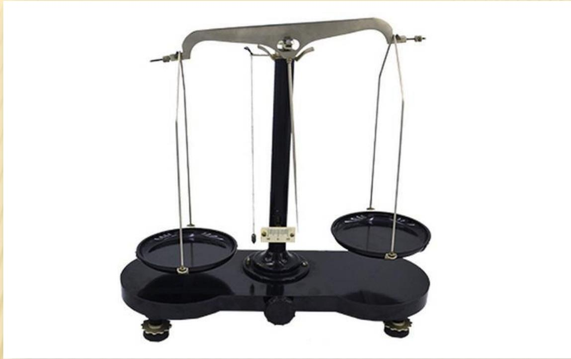
Также на принципе рычага основано действие рычажных весов. Например, рычажные весы действуют как равноплечий рычаг. Устройство весов для взвешивания грузовых автомобилей и вагонов тоже основано на правиле рычага.
