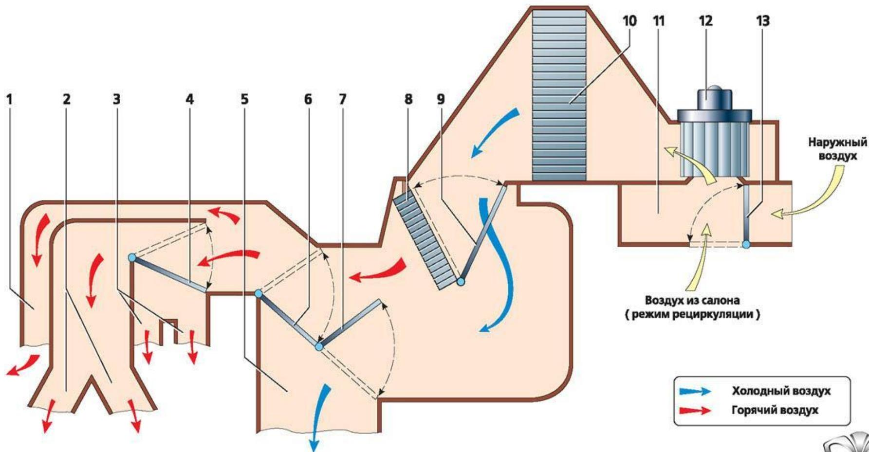
■ **Схема движения воздуха в системе отопления, вентиляции и кондиционирования:**
