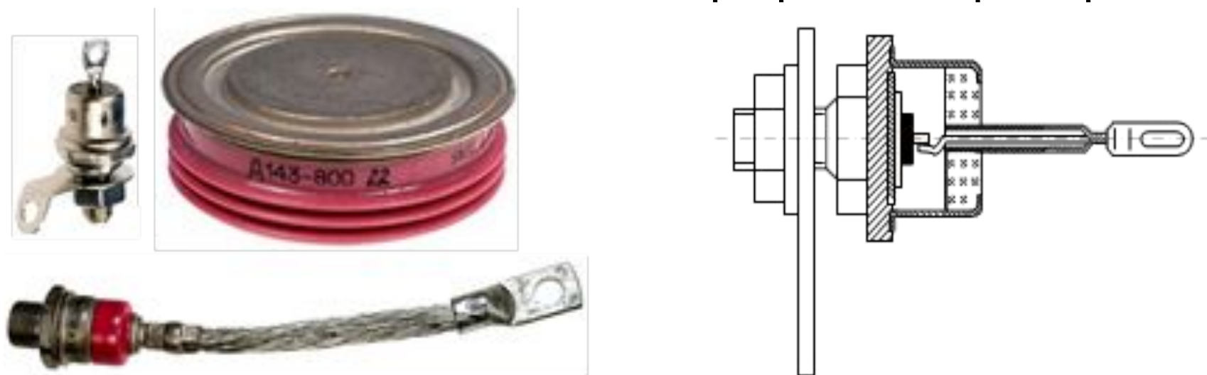
Рис. 5. Мощные выпрямительные диоды: дискретное исполнение (а); диодный силовой модуль (б); конструкция одного из диодов (в)
