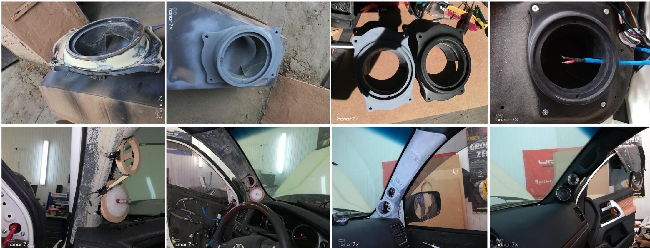
**СЧ и ВЧ Акустические динамики системы установлены в подиумы на стойках автомобиля, для среднечастотных динамиков был создан **объем 0,250 миллилитра**, для НЧ динамиков **дополнительная защита ограничивающая попадание влаги** на катушки динамиков и доворотом проставочных колец при этом в штатных местах автомобиля. Все динамики болтовое крепление с нержавеющей крепежом и закладными. Пайка контактов всей аудиосистемы осуществлена серебряным припоем Tchernov Audio Cable.**
