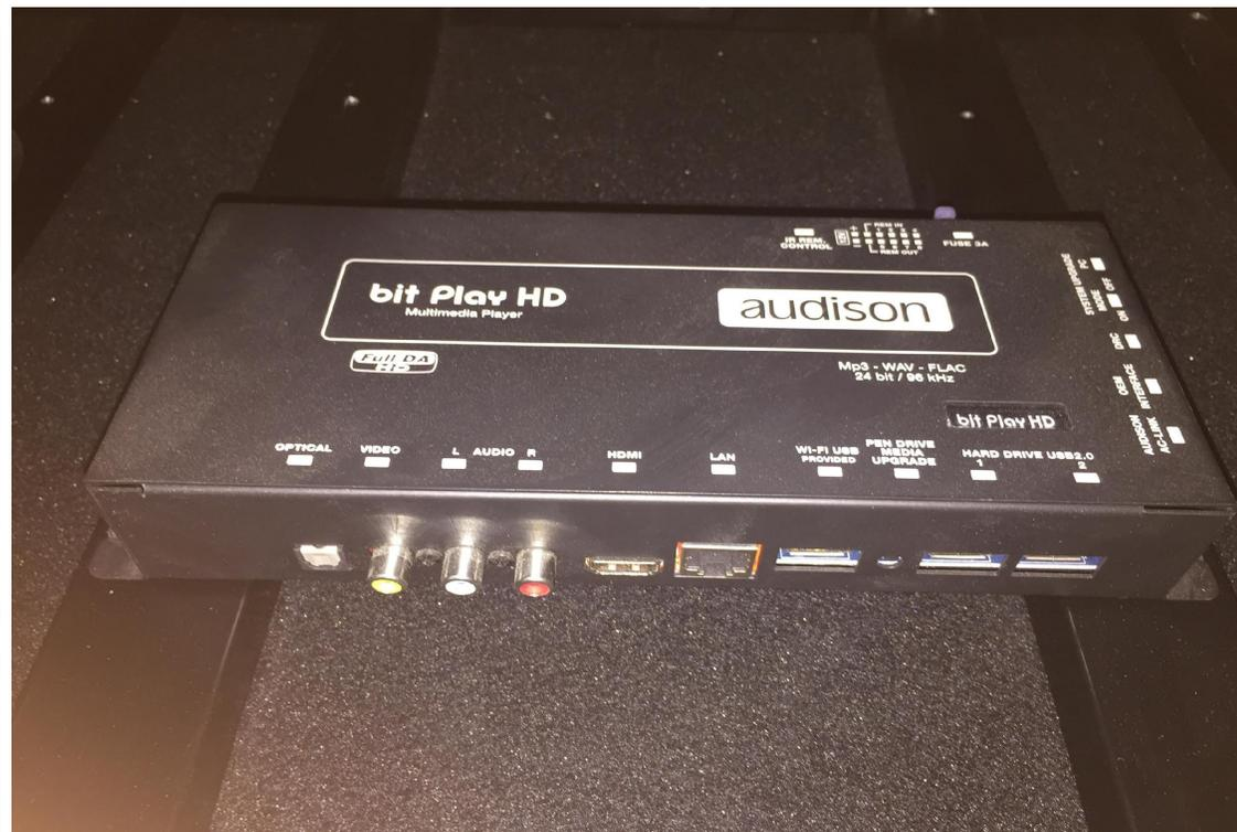
**Источником звука в системе является мультимедийный плеер Audison Bit Play HD имеющий на борту SSD жесткий диск возможность подключения сразу 2-х USB устройств (флешки, жесткие диски) и поддерживающий формат качественного звучания без сжатия FLAC. Головное устройство установлена на сварной раме внутри электрического фальшпола с доводчиками с использованием закладных и винтовым креплением для надлежащей фиксации.**
