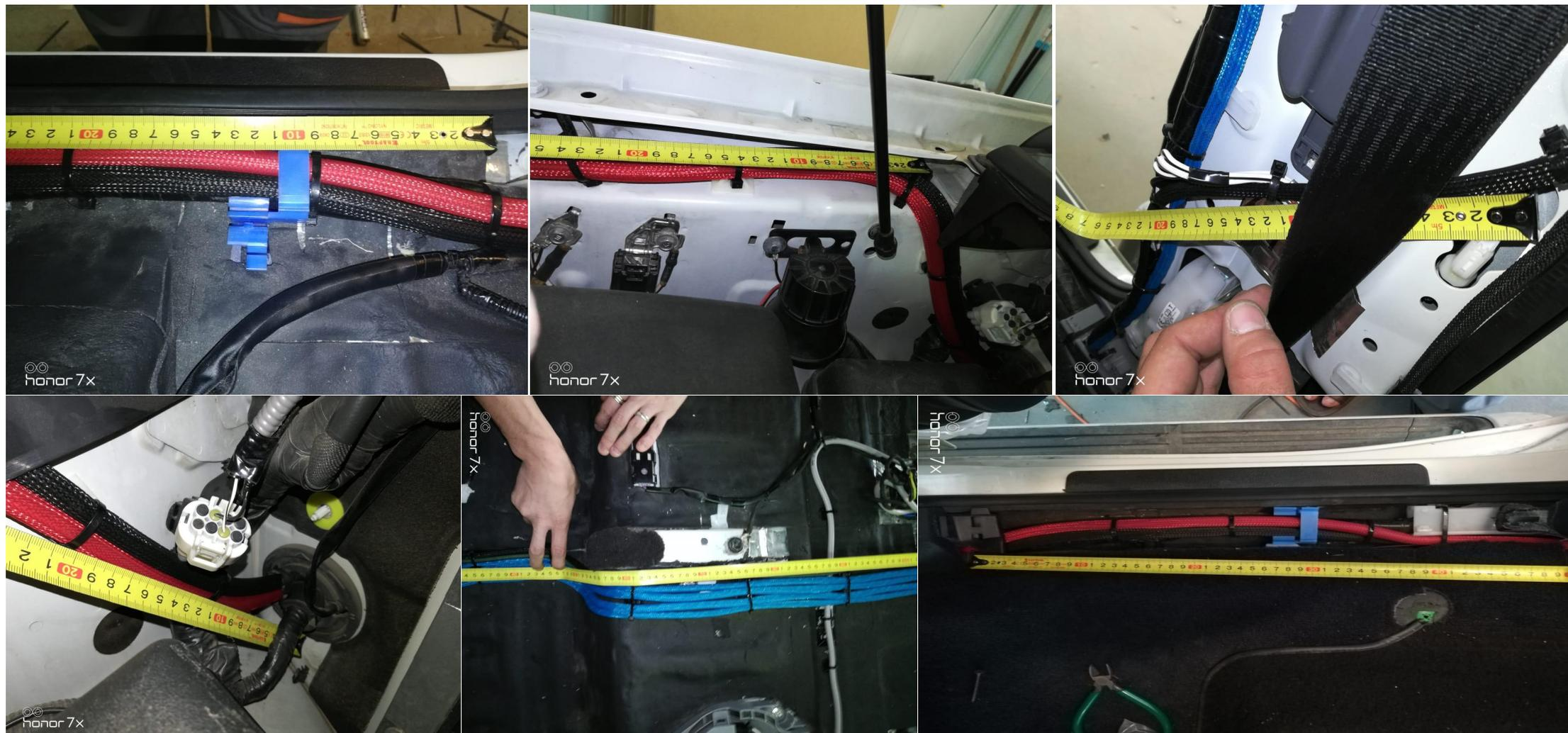
**Вся силовая, акустическая и линейная проводка в автомобиле надежно закреплена с использованием как штатных коробов автомобиля с креплением, так и дополнительно закреплена площадками и стяжками на расстоянии не более 15 см друг от друга. Дополнительно в местах прохода через металл проводка защищена гофрированными трубками и оболочкой «Змеиная шкура».**
