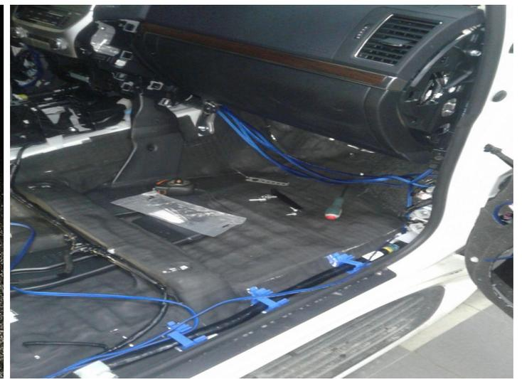
**Выполнена полная тройная шумоизоляция автомобиля включая арки с полным разбором салона материал - ШумоFF**
