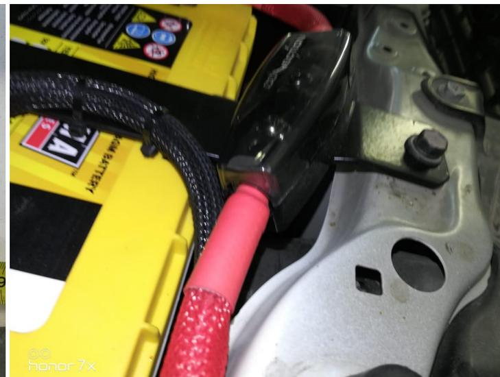
Один из штатных аккумуляторов был заменен на Optima Yellow Top и изготовлена крепежная рама и монтажная площадка для предохранителя
