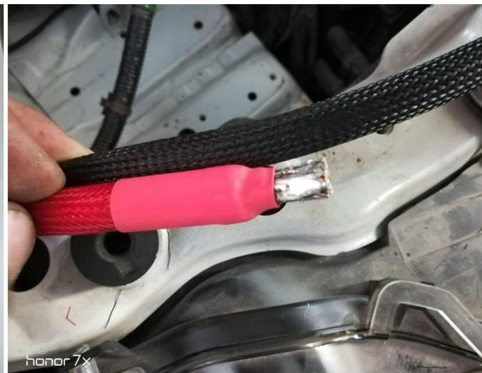
Вся проводка музыкальной системы дополнительно защищена и убрана в **ДВОЙНУЮ** в термоусадочную трубку с клеевой основой. Любое соединение в системе имеет надлежащую защиту от повреждений в процессе эксплуатации автомобиля.
