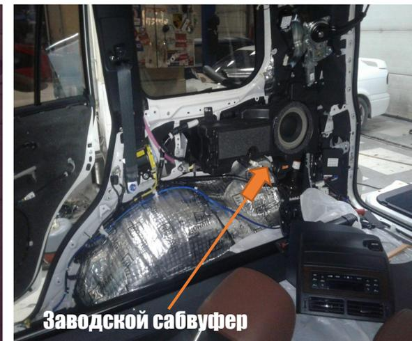
**Для сабвуферного динамика Laudio 10W3V3-2 был создан корпус «стелс» объемом 22 литра, дополнительно полностью переделана штатная обшивка правого крыла для косметической интеграции фальшпанели для сабвуферного динамика. Также полностью левая и правая обшивки были перетянуты в гладкую кожу Narra включая все элементы обшивок, как лючки так и заглушки.**
