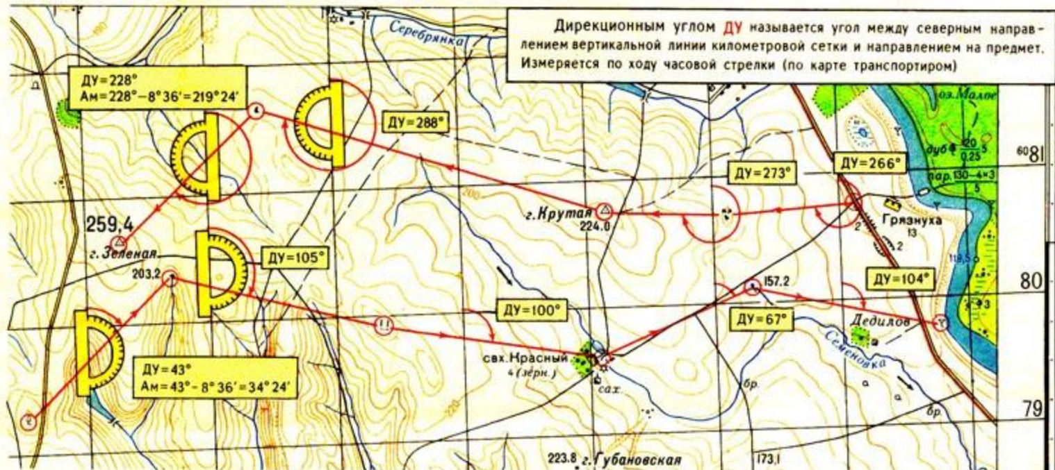
Определение магнитных азимутов по измеренным дирекционным углам
