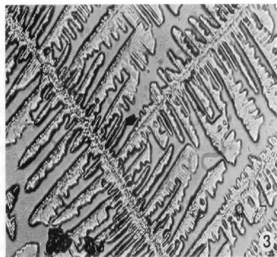
Fig. 3. En el interior del eje principal se identifican pequeños cristales. Se observa cómo de los ejes principales nacen otros secundarios (flecha corta). Muestra 17S. ML x 40.
