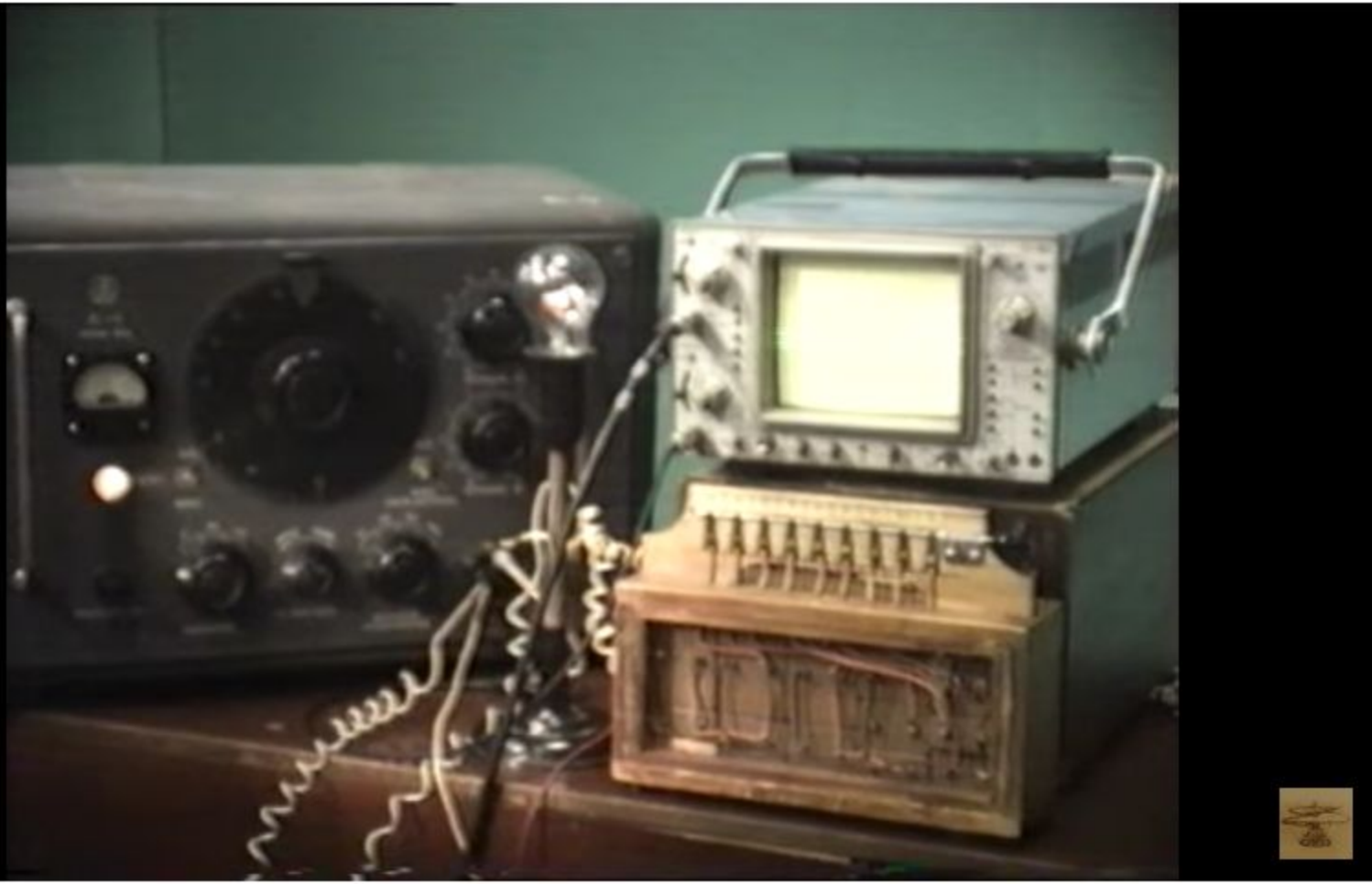
Фазовые соотношения в цепи с конденсатором
