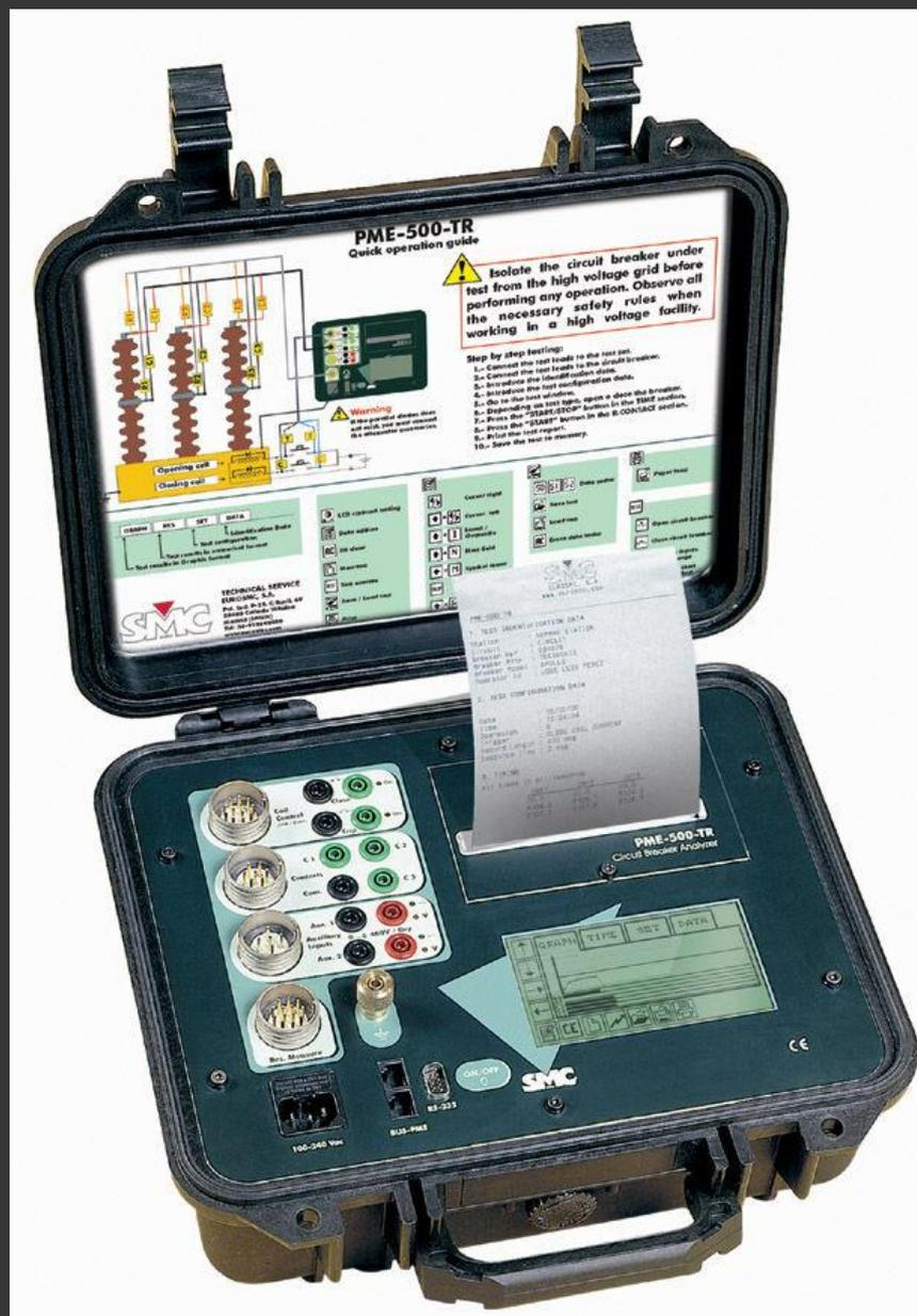
Прибор предназначен для контроля правильности работы выключателей среднего и высокого класса напряжений
