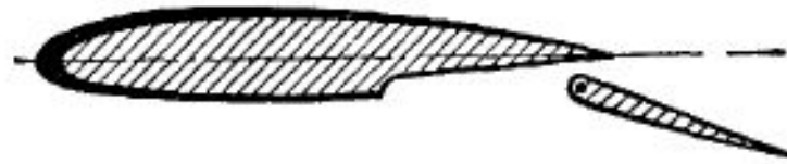
Профиль крыла со щитком, смещенным назад
