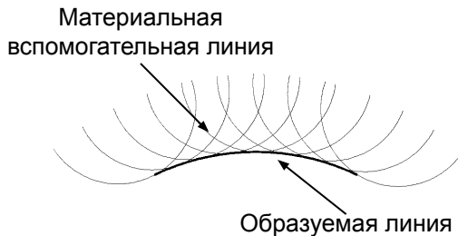
б) Метод обката – одно движение формообразования
