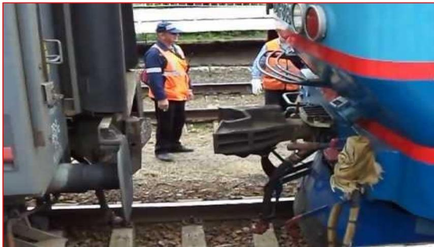
Ответственным за техническое состояние автосцепных устройств и правильное сцепление вагонов в составе поезда является осмотрщик вагонов, выполняющий техническое обслуживание состава поезда перед отправлением.
