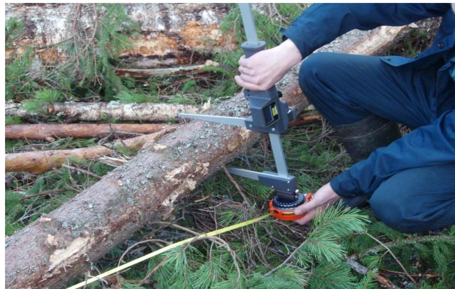
8. Теперь на дисплее мерной вилки отражается расположение следующей точки измерения (150 см). Используйте представленный выше способ для проведения измерений в этой и во всех остальных точках бревна, не забывайте прислушиваться к звуковым сигналам.
