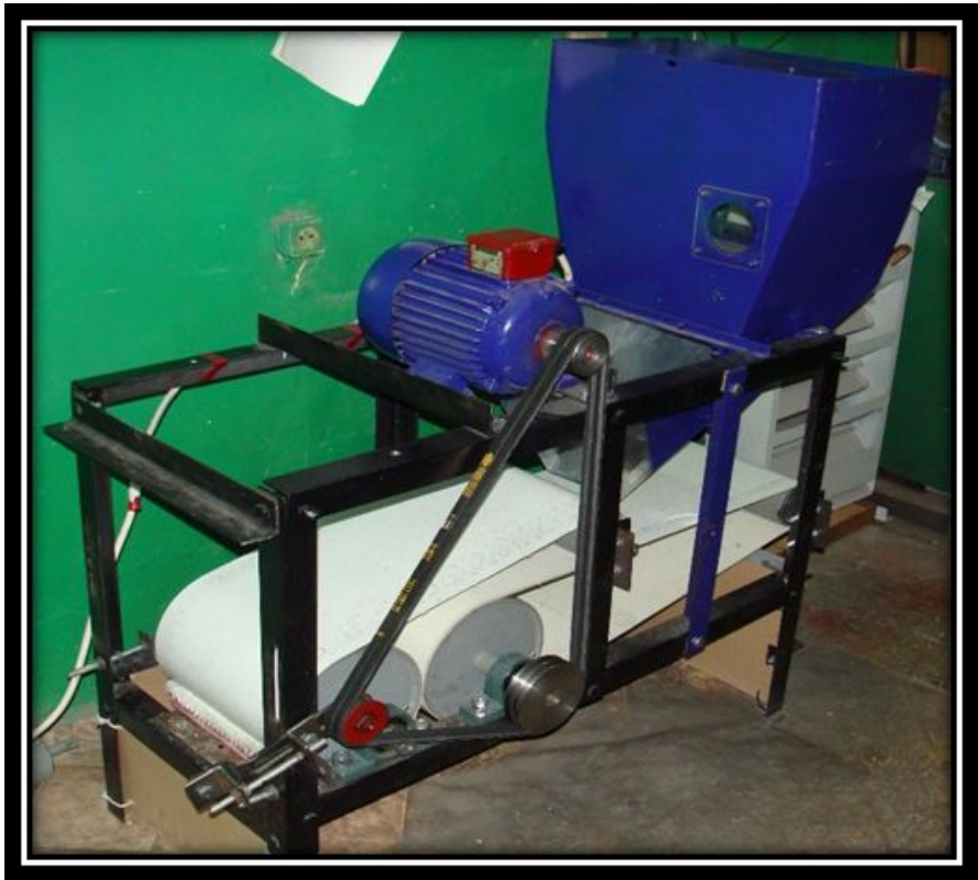
Плющилка зерновой смеси высокой влажности
