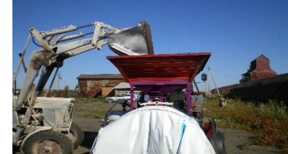
Плющение зерновой смеси, внесение консерванта
