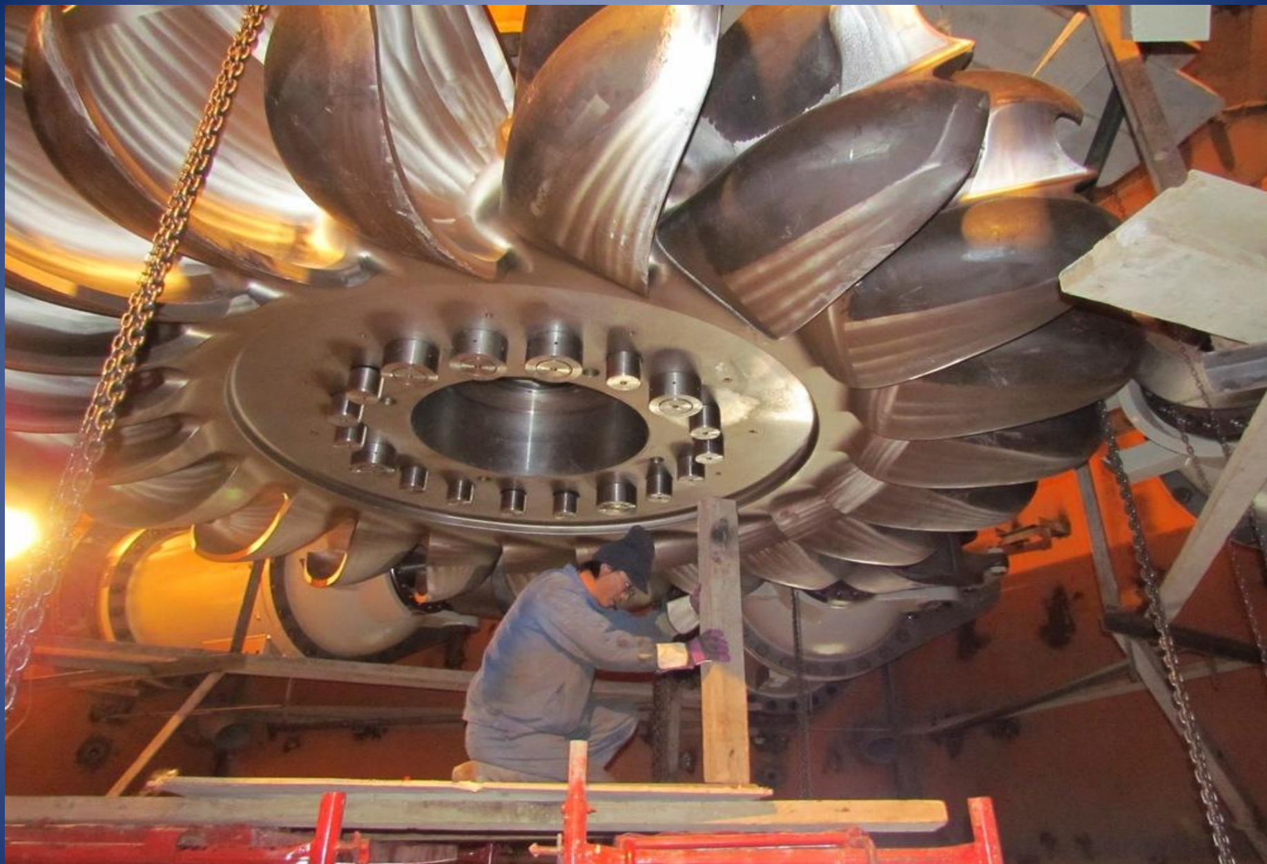
Ковшовое рабочее колесо для гидротурбины Мойнакской ГЭС
