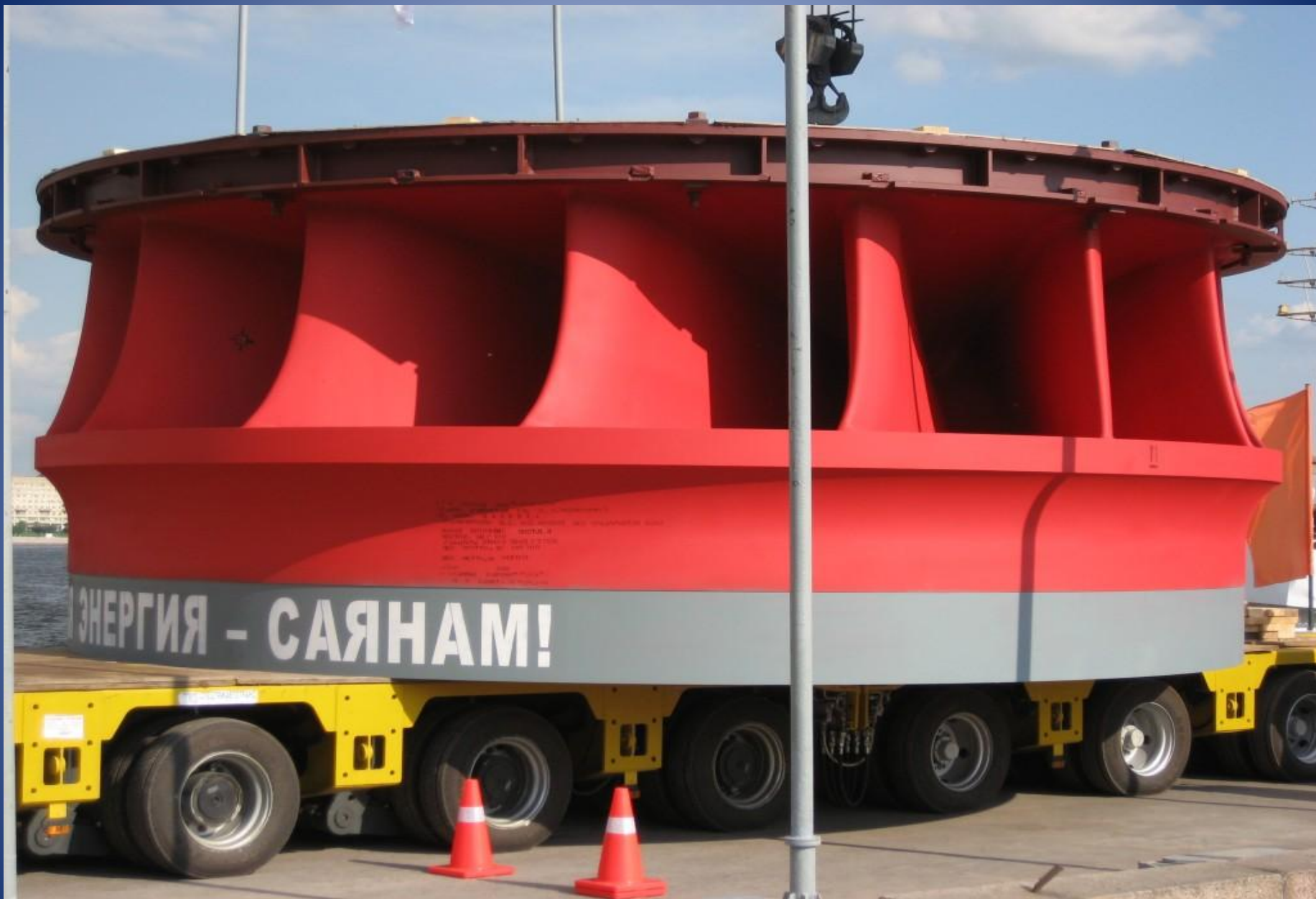
Радиально-осевое рабочее колесо для гидротурбины Саяно-Шушенской ГЭС
