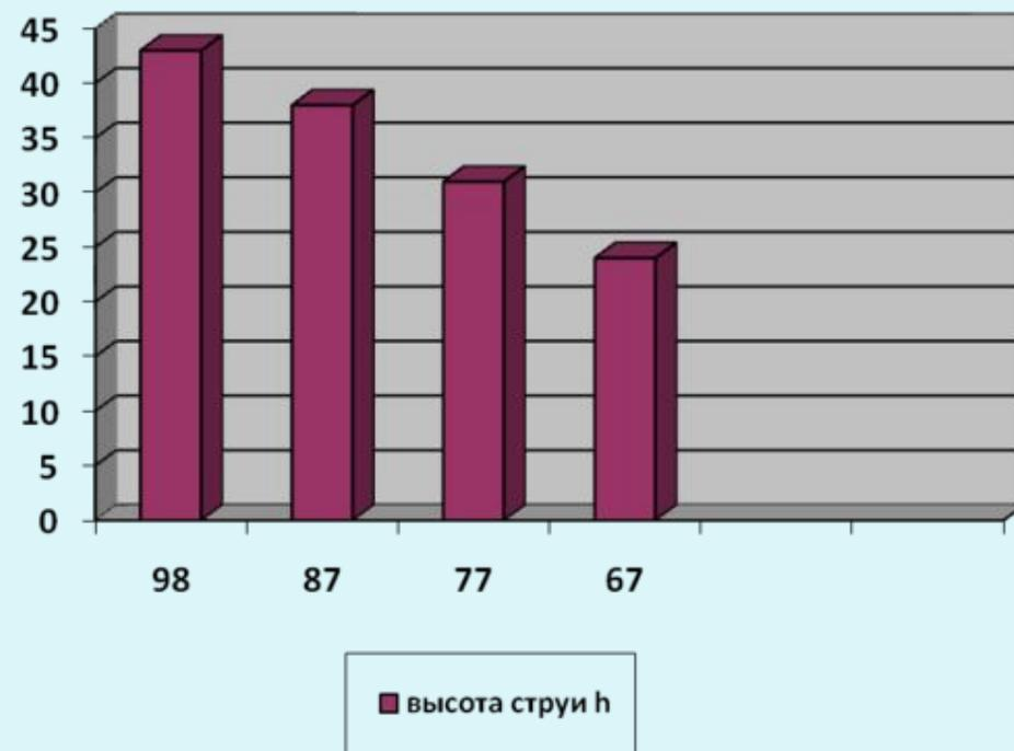
Зависимость  $h$  от диаметра отверстия  $d_1$  стеклянного наконечника .
