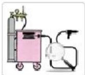
Основной механизм подачи проволоки толкающего типа и горелка с встроенным механизмом «ПУШ-ПУЛ»
