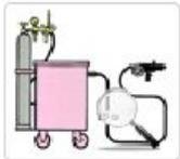
Основной механизм подачи проволоки толкающего типа с обычной горелкой
