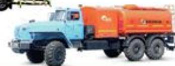
Передвижные и стационарные агрегаты фильтрации топлива (АФТ-П, АФТ-С)
