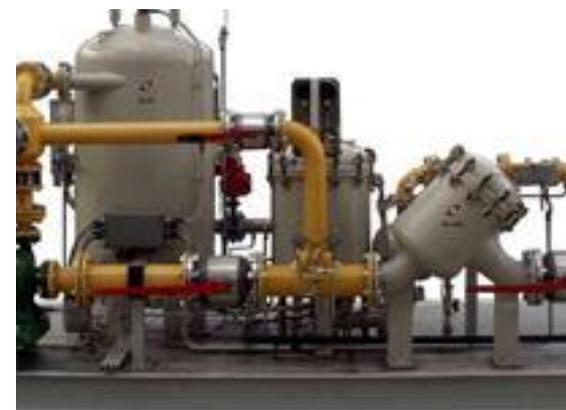
**Индукционный нейтрализатор статического электричества в потоке топлива ИНСЭТ** предназначен для снижения плотности зарядов статического электричества в потоке авиатоплива
