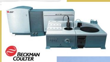
Лазерный анализатор размеров частиц LS 13320, Beckman-Coulter
