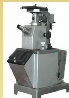
Микроскоп металлографический МИМ-8
