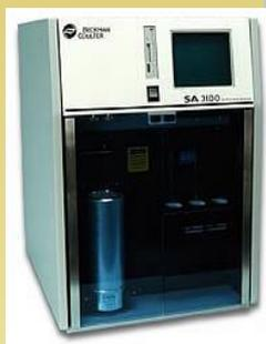
SA™ 3100 Анализатор удельной поверхности и пористости, Beckman-Coulter
