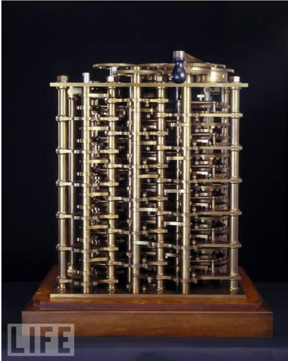
1824: Разностная машина Чарльза Бэббиджа — первый успешный автоматический калькулятор. Часть ее, показанная на фотографии, была собрана в 1832 году инженером Бэббиджа, Джозефом Климентом. Она состоит из примерно 2000 частей и представляет собой одну седьмую часть предполагаемой полной «Разностной машины Чарльза Бэббиджа».
