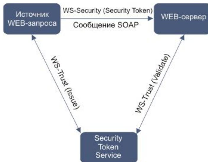
Рис. 1. Безопасность WS передает идентификационные данные с помощью Security Token, созданного STS
