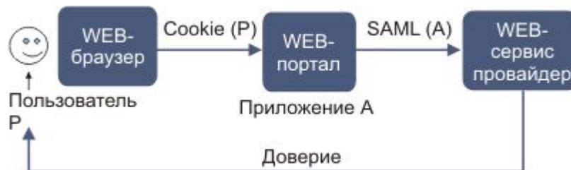
Рис. 3. Идеальная ситуация. Web-сервис провайдер доверяет пользователю, обеспечивая безопасность end-to-end
