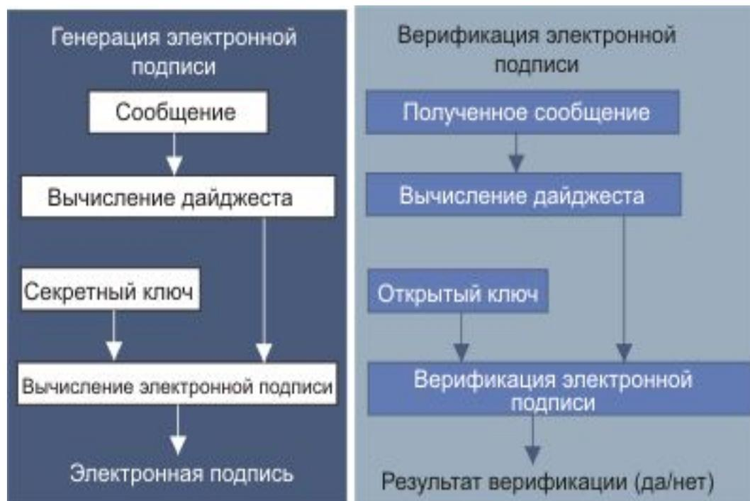
Рис. 9. Схема вычисления и верификации электронной подписи (DSA)
