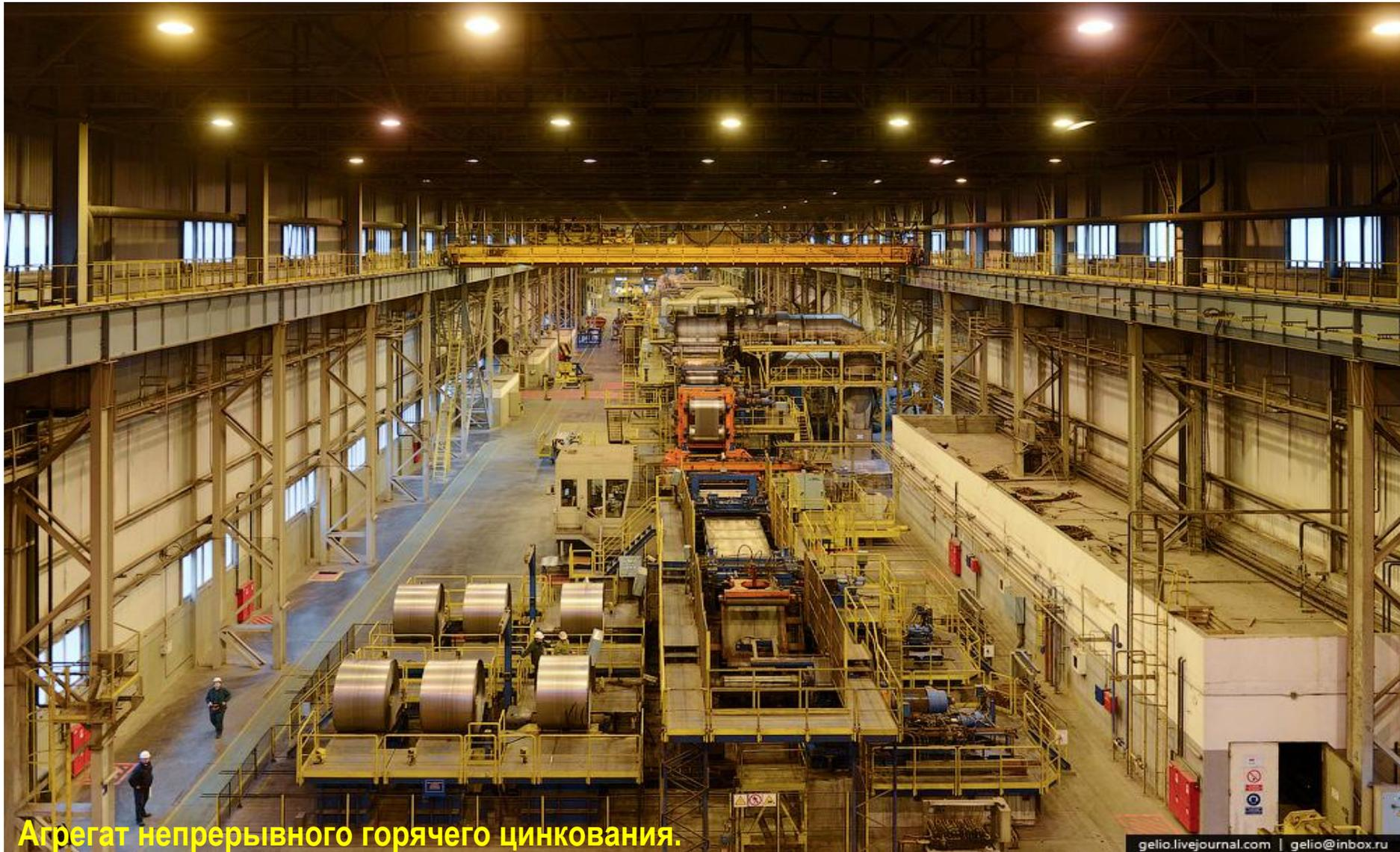
**Агрегат непрерывного горячего цинкования.**
