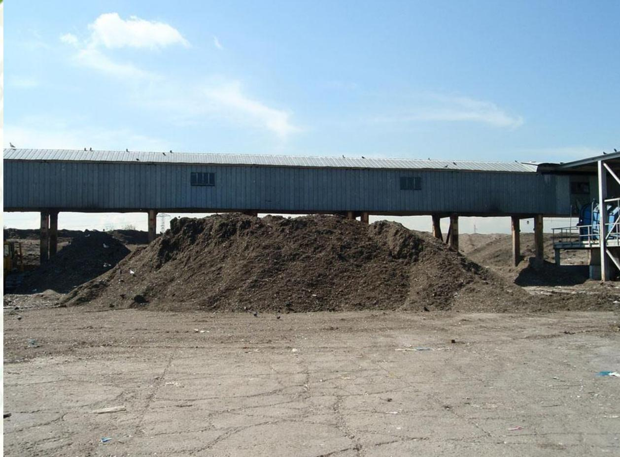
**В результате биотермической переработки ТБО полученное биотопливо складировается в бурты на площадку дозревания. После дозревания образуется конечный продукт — компост.**
