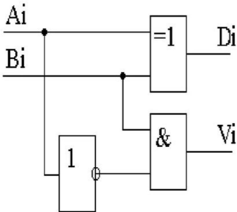
Схема полувычитателя отличается от схемы полусумматора только наличием инвертора по сигналу А.
