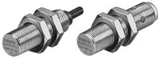
Бесконтактный датчик с электрическим выходом тип SMT0, работает по принципу возбуждения осциллирующего тока в колебательном контуре при приближении магнита
