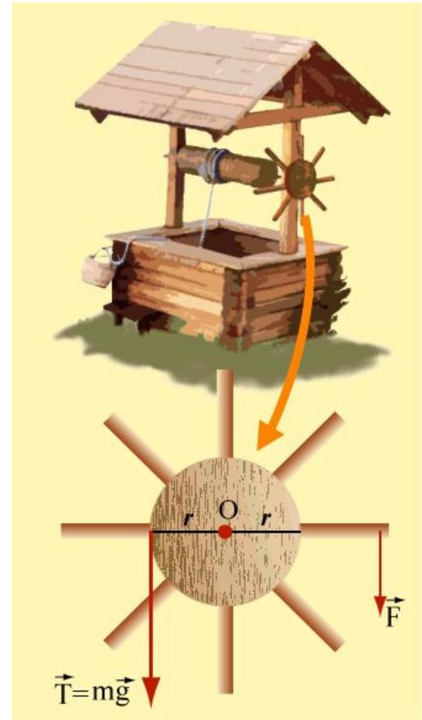
Для увеличения коэффициента полезного действия механизма часто стараются уменьшить силу трения. Это можно сделать, используя различные смазки или шарикоподшипники, в которых трение скольжения заменяется трением качения.
