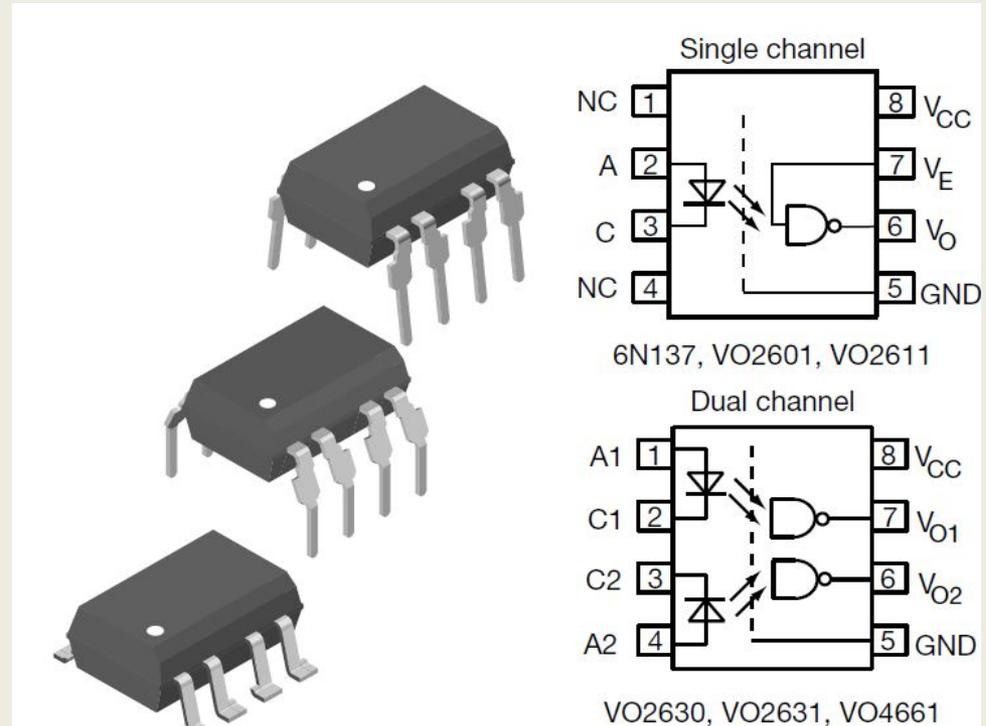
Рис. 11 – Элементы оптронной развязки
