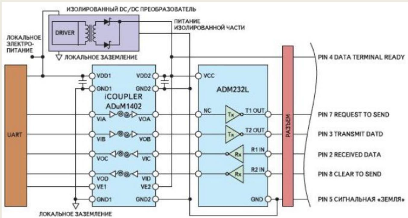
Рис. 13 – Микросхемы трансформаторной развязки
