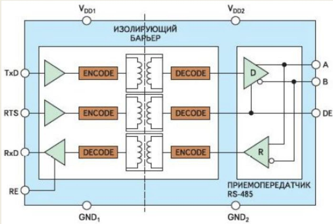
Рис. 14 – Микросхема изоляции интерфейса RS-485
