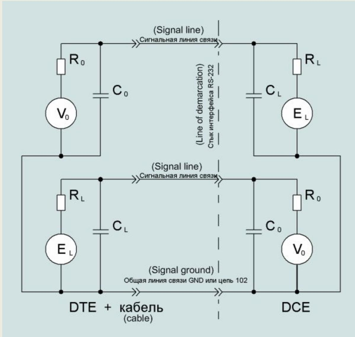
Рис. 2 – Практическая схема стыка интерфейса RS-232C
