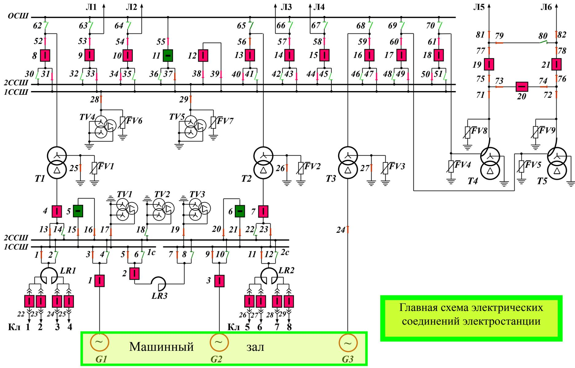
Главная схема электрических соединений электростанции
