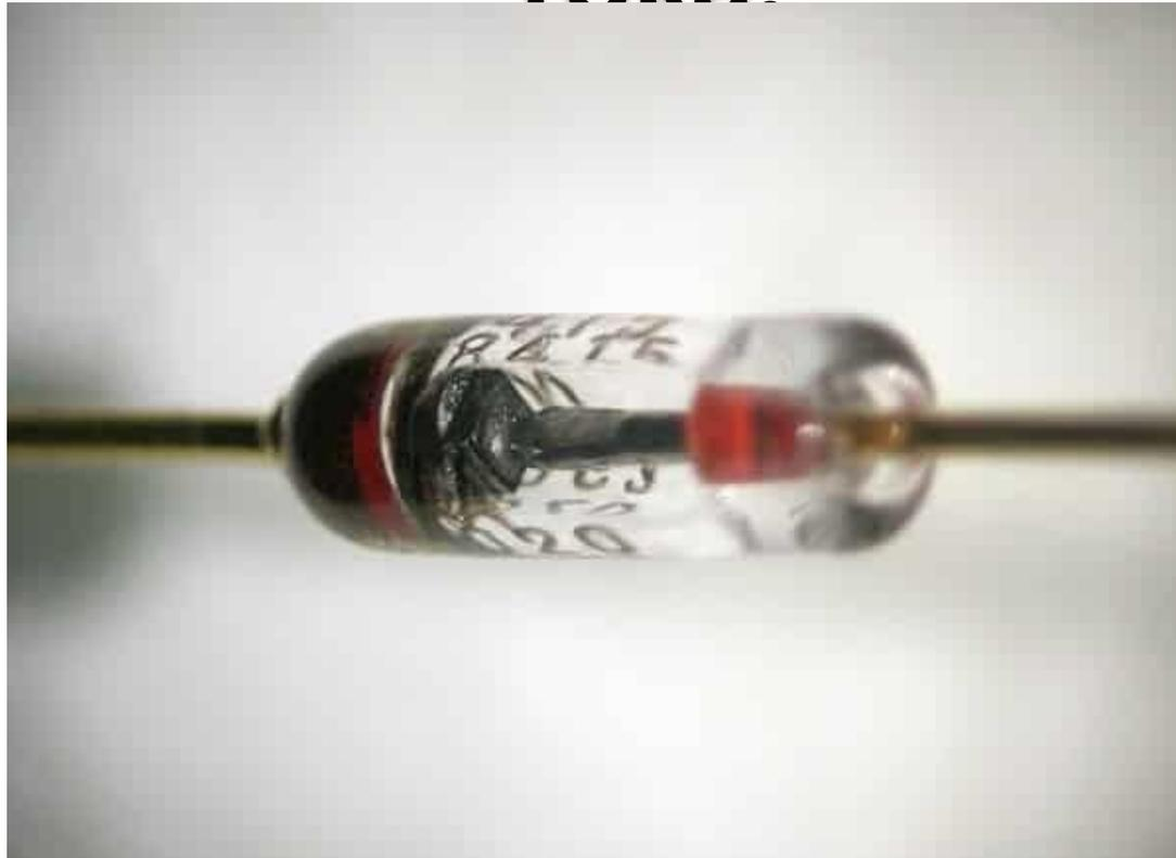
**Диод** — простейший полупроводниковый прибор, который можно встретить сегодня на печатной плате любого электронного устройства. В зависимости от внутренней структуры и технических характеристик, диоды классифицируются на нескольких видов: универсальные, выпрямительные, импульсные, стабилитроны, туннельные диоды и варикапы.
