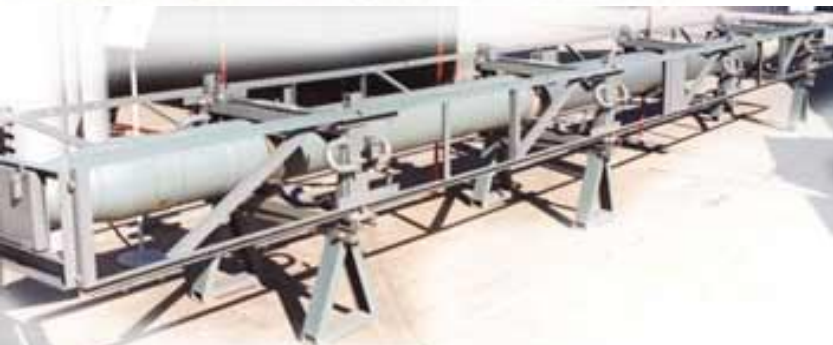
300мм. реактивный снаряд 9М55С с термобарической боевой частью. Этот снаряд используется реактивной системой залпового огня (РСЗО) Смерч.
