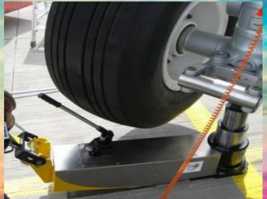
**Гидродомкраты** применяются для замены поврежденных колес шасси, замены тормозов.
