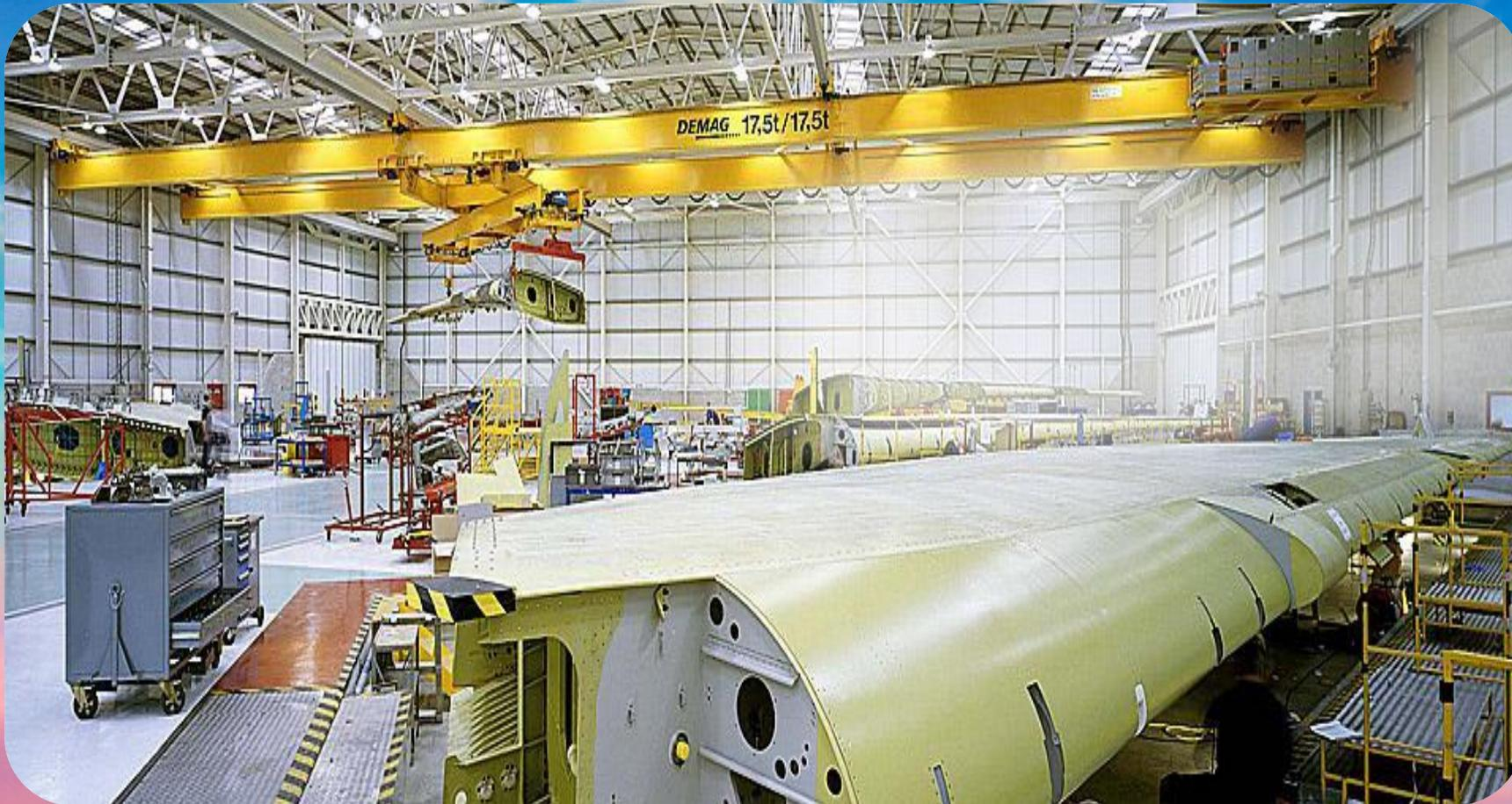
**Кран** – балки отличаются универсальностью и относительно компактными размерами, в связи с чем их широко применяют для работ в труднодоступных для остальных видов кранов местах.
