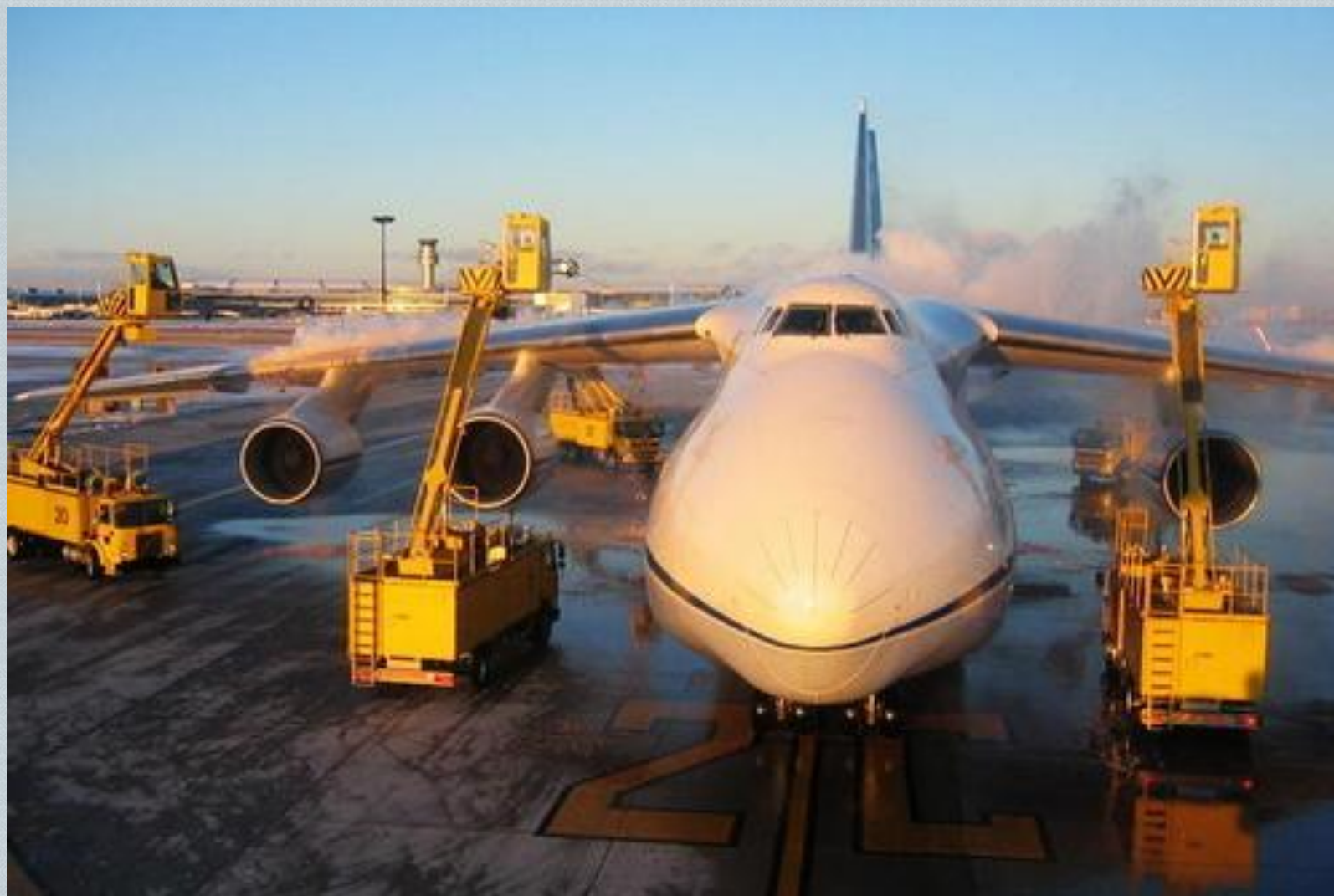
Обработка самолета Ан-124 шестью машинами
