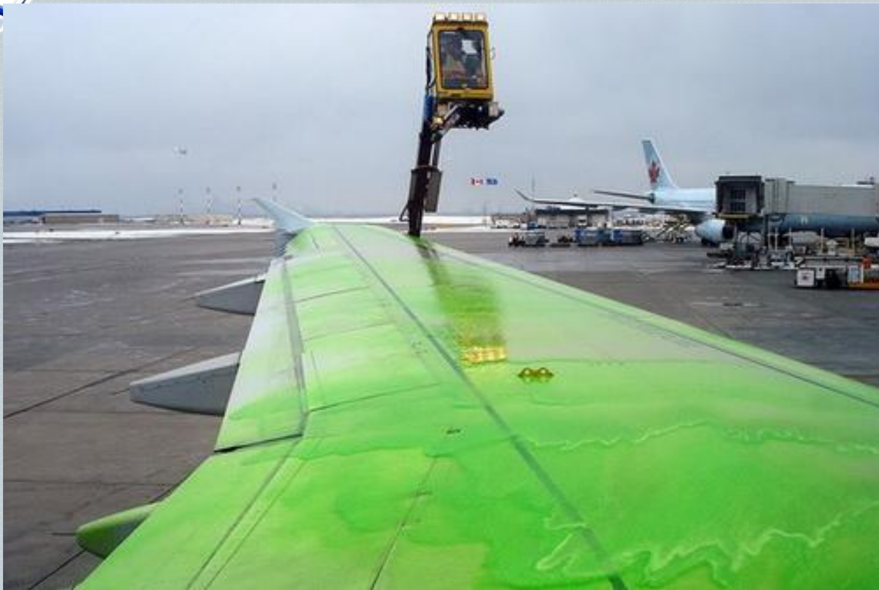
Обработка крыла защитной жидкостью
