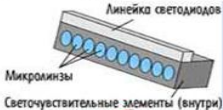
Рис. 2.19. Устройство сканирующей головки: 1 — набор светодиодов; 2 — линзы; 3 — фотоэлементы; 4 — регистр сдвига; 5 — видеоусилитель; 6 — выход (АЦП)
